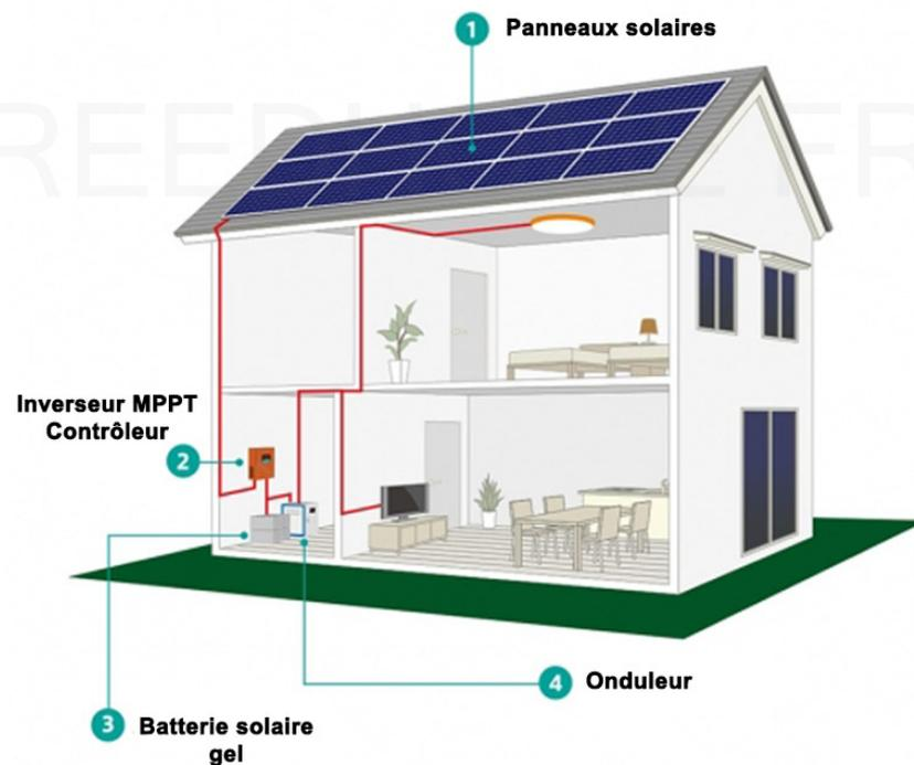
Ce kit solaire est prévu pour une consommation de 12 kWh par jour. Livré avec 12 panneaux solaires (fixation toit/sol incluse) de 280 w garantie 25 ans, 1 contrôleur MPPT pouvant se connecter au Groupe Electrogène pour charger les batteries par temps nuageux, 1 onduleur, 8 batteries de 150 AH, 6 paires de connecteur et 100 mètres de câble.
